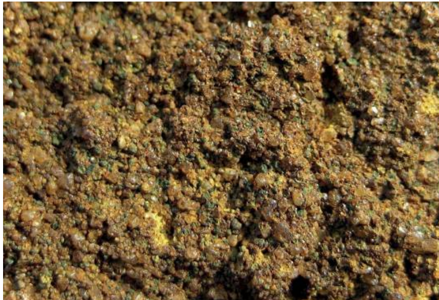
Fig. 33 - Grès diestien. Macrophoto montrant notamment de l'hématite et des grains non oxydés de glauconie, ce qui permet de distinguer le grès ferrugineux diestien du grès ferrugineux bruxellien dans lequel toute la glauconie a été oxydée et n'apparaît donc plus (photo R. Dreesen).
